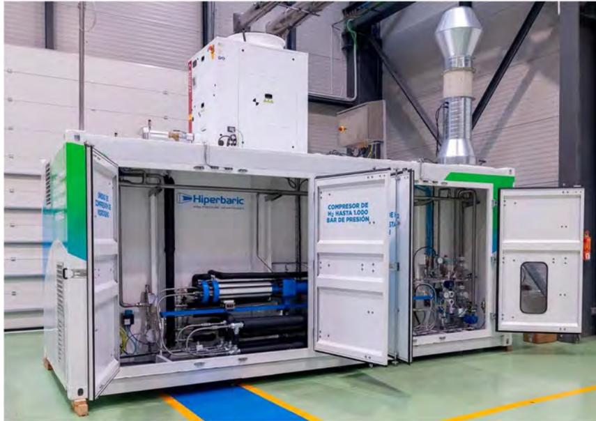
*Ilustración 11. Estación compresora contenerizada. (Fuente: Hiperbaric)*
